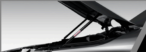
อุปกรณ์ช่วยผ่อนแรงเปิด-ปิด ฝากระโปรงหน้า
